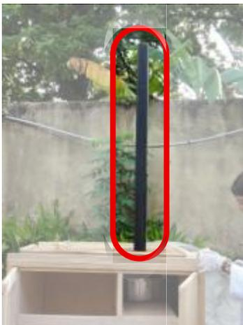
s'agit d'un système basé sur la création d'un vortex qui existe grâce au rayonnement solaire. Ce dernier est accumulé par le tuyau sortant du toit, d'où l'utilisation de la fonte (étant un métal, c'est un bon conducteur thermique) qui de plus est peint en noir (il a tendance à emprisonner la chaleur émise par le soleil).
